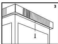
**SCHRITT 3** Schrauben Sie die Oberseite des Marino mit den mitgelieferten Schrauben mit einem Kreuzschlitzschraubenzieher (nicht mitgeliefert) fest.
