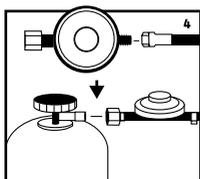
**SCHRITT 4** Schließen Sie den Druckregler 50 mbar an die Gasflasche (maximal zulässige Füllmenge beträgt 10,5 kg) mit einem gut passenden, verstellbaren Schraubenschlüssel an. Es reicht nicht aus, ihn nur handfest anzuziehen, denn dies kann eine Leckage mit möglicherweise sehr gefährlichen Situationen zur Folge haben.
