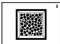
**SCHRITT 2** Verteilen Sie die mitgelieferten Steine gleichmäßig auf dem Brennerbett. Achten Sie darauf, dass hierbei keine feinen Steinsplitter in den Brenner gelangen.
