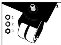
**SCHRITT 1** Befestigen Sie, falls erwünscht, die Rollen am Geräteboden. Montieren Sie die Teile von der Unterseite her gesehen in folgender Reihenfolge: Gewindestift – Rolle – Marino – Unterlegscheibe – Federscheibe – Mutter. Benutzen Sie zum Festziehen den mitgelieferten Schraubenschlüssel.
